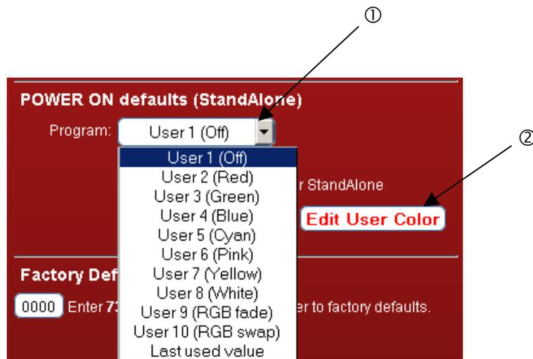
Mit klicken auf *User Color Setup* im Main Menü des Webinterfaces wird der Dialog USER COLOR SETUP zum editieren des benutzerdefinierten Farbwechsel / Programms angezeigt:
