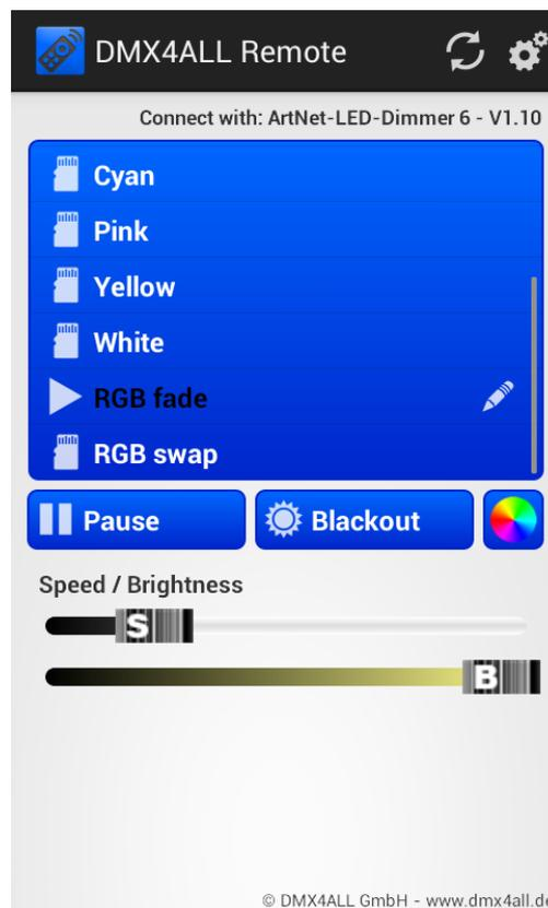
Durch antippen eines Programmnamens in der Liste wird das entsprechende Programm im ArtNet-LED-Dimmer ausgeführt. Das ausgeführte Programm wird mit einem ► Symbol gekennzeichnet.
