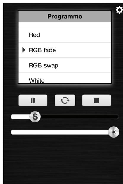
Durch antippen eines Programmnamens in der Liste wird das entsprechende Programm im ArtNet-LED-Dimmer ausgeführt. Das ausgeführte Programm wird mit einem ► Symbol gekennzeichnet.
