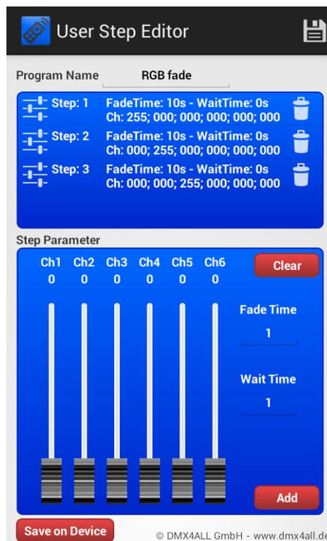
Eine Liste der einzelnen Schritte wird angezeigt. In jedem Eintrag werden FadeTime, WaitTime und die Kanalwerte angezeigt.
