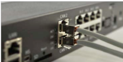
Abb.: Jedes Zertico Überwachungssystem ist mit 2 CAN-Bus Ports ausgestattet. An jedem einzelnen CAN-Bus können per Plug'n Play bis zu 8 CAN-Sensoren / CAN-Units mit einer Gesamtlänge von bis zu 300 Metern angeschlossen werden.
