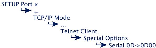
Ist dieser Schalter aktiviert, wird an das seriell empfangene Zeichen `0x0D` ein `0x00` angehängt: Über das Netzwerk wird also `0x0D 0x00` übertragen. Diese Option muss unter Umständen bei der Übertragung binärer Dateien innerhalb der Telnet-Session aktiviert werden.
