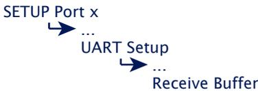
Der Com-Server verfügt über einen einstellbaren, seriellen Empfangsbuffer von ca. 4kB. Der Menüpunkt erlaubt die Reduzierung dieses Wertes. Ob der serielle *Receive Buffer* bei einem Verbindungsaufbau automatisch gelöscht wird oder eventuell vorhandene ältere Daten an die Anwendung übertragen werden, bestimmt die Option *Flush Buffer*. Details enthält das Kapitel *Die Basiskonfiguration des Com-Servers*.
