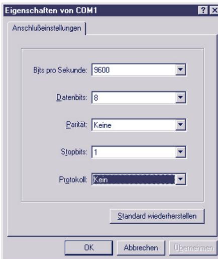
4. Nachdem die Einstellungen mit *OK* quittiert wurden, befinden Sie sich im eigentlichen Terminalfenster. Alle Tastatureingabe werden über den ausgewählten COM-Port ausgegeben. Führen Sie jetzt durch Unterbrechen der Spannungsversorgung des Com-Servers einen Reset durch und halten während des Neustarts die x-Taste (klein, ohne CapsLock!) gedrückt. Nach ca. 2-3 Sekunden erscheint im Hyperterminal die Eingabeaufforderung *IP no.:+<ENTER>.*
