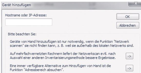
Tragen Sie in das entsprechende Eingabefeld die IP-Adresse des Com-Servers ein. Durch Schließen des Dialoges mit *OK* wird das Gerät in die Inventarliste aufgenommen.
