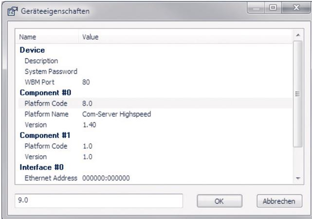
Markieren Sie in den Eigenschaften die Zeile *Component#0* → *Platform code* und tragen für den Com-Server++ sowie den Com-Server 20mA den Wert *9.0* in das Eingabefeld ein. Für den Com-Server 3x Isolated verwenden Sie den Platform Code *9.2*.
