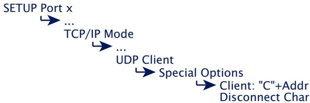
In dieser Betriebsart werden die Adressdaten des Zielsystems nicht fest konfiguriert, sondern als Steuerstring vor den eigentlichen Nutzdaten seriell an den Com-Server übermittelt. Hierdurch ist es möglich, Verbindungen zu wechselnden UDP-Servern aufzunehmen.
