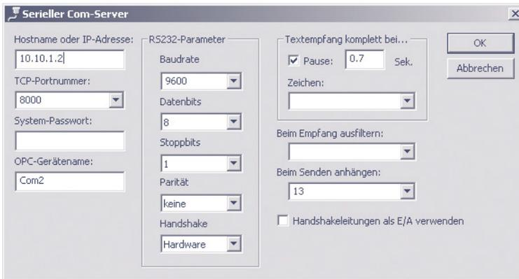
In die entsprechenden Felder des folgenden Fensters werden die benötigten Verbindungsdaten des Com-Servers bestehend aus IP-Adresse, TCP-Port und Systempasswort eingetragen.
