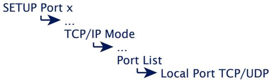
Für einen Verbindungsaufbau zum Com-Server benötigt ein Client neben der IP-Adresse die TCP-Portnummer. Der direkte Zugriff per TCP auf die seriellen Schnittstellen des Com-Servers erfolgt über die im oben angeführten Menüweig hinterlegte Portnummer. Ab Werk sind die Werte 8000, 8100, 8200 für die seriellen Ports A, B, C vorgegeben.
