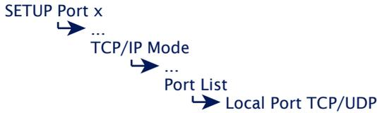
Um ein UDP-Datagramm an den Com-Server zu senden, benötigt ein UDP-Peer neben der IP-Adresse die UDP-Portnummer. Der direkte Zugriff per UDP auf die serielle Schnittstelle des Com-Servers erfolgt über die im oben angeführten Menüweig hinterlegte Portnummer. Ab Werk sind die Werte 8000, 8100, 8200 für die seriellen Ports A, B, C vorgegeben.
