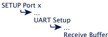
Der Com-Server verfügt über einen einstellbaren, seriellen Empfangsbuffer von ca. 4kB. Der Menüpunkt erlaubt die Reduzierung dieses Wertes. Ob der serielle *Receive Buffer* bei einem Verbindungsaufbau automatisch gelöscht wird oder eventuell vorhandene ältere Daten an die Anwendung übertra-
