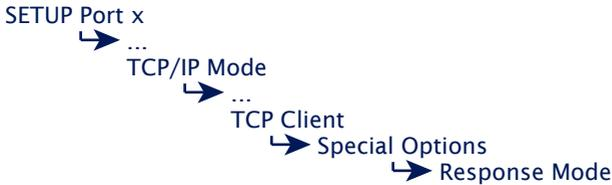
Im *Response Mode* wird die Applikation im seriellen Endgerät durch die Ausgabe spezieller Zeichen über den netzwerkseitigen Verbindungszustand des Com-Servers informiert. Diese Funktion ist ausschließlich in der Betriebsart TCP-Client verfügbar und liefert folgende serielle Meldungen.
