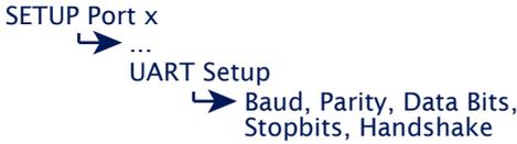
Baudrate, Datenbits, Parität und Handshake-Verfahren müssen konform zu dem angeschlossenen seriellen Gerät konfiguriert sein. Details hierzu enthält das Kapitel *Die Konfiguration des seriellen Ports*.
