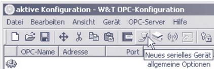
Nach Start des OPC-Konfigurationstools, wird über den Button *Neues serielles Gerät* der Dialog für die Integration eines Com-Servers gestartet:
