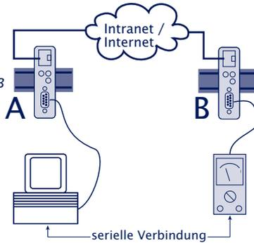
**Beispiel 2:** Ein Steuer-Programm pollt ein Messgerät, das Messgerät kann aktiv Daten an das Steuer-Programm übermitteln.
