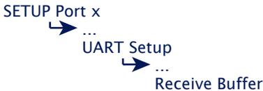
Der Com-Server verfügt über einen einstellbaren, seriellen Empfangsbuffer von ca. 4kB. Der Menüpunkt erlaubt die Reduzierung dieses Wertes. Ob der serielle *Receive Buffer* bei einem Verbindungsaufbau automatisch gelöscht wird oder eventuell vorhandene ältere Daten an die Anwendung übertragen werden, bestimmt die Option *Flush Buffer* im oben angeführten Menüweig. Details enthält das Kapitel *Die Basis-konfiguration des Com-Servers*.
