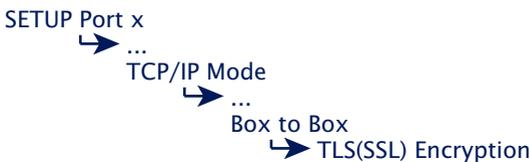
Die TCP-Verbindung zwischen Box-to-Box-Master und -Slave wird über TLS/SSL verschlüsselt. In Zusammenhang mit der
