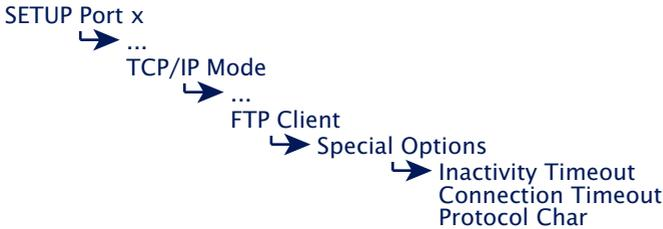
Unabhängig davon, ob mit dem Automatik-Modus oder dem seriellen Protokoll gearbeitet wird, erfolgt das Schließen der FTP-Verbindung entweder zeitgesteuert oder bei einer ASCII-Übertragung auch mit Hilfe des *Protocol Chars*.
