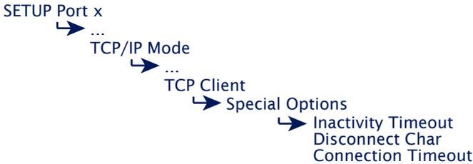
Für das Schließen der Verbindung stehen in diesem Unterme­nü die nachfolgenden Methoden zur Verfügung. Bei einer Ver­bindungssteuerung über die Handshake-Eingänge *CTS* oder *DSR*, erfolgt der Verbindungsabbau auch bei Abfallen dieser Leitungen.
