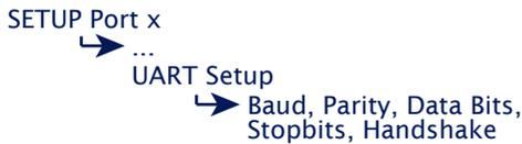
Baudrate, Datenbits, Parität und Handshake-Verfahren müssen konform zu dem angeschlossenen seriellen Gerät konfiguriert sein. Bei paarweisem Einsatz müssen beide als SLIP-Router arbeitenden Com-Server hinsichtlich der Baudrate, Parität, Datenbits und Stopbits identisch eingestellt sein.
