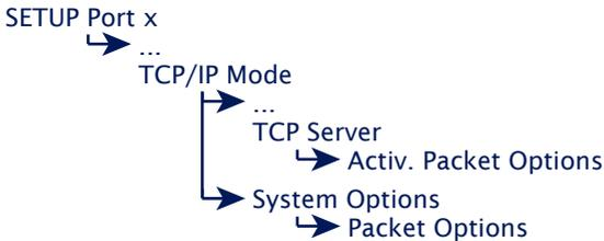
Bei der Übertragung serieller Protokolle wie zum Beispiel Modbus/RTU, ist es oft notwendig seriell empfangene Datagramme auch netzwerkseitig geschlossen in einem TCP-Paket zu übertragen. Die oben angeführten Menüzeile bieten diverse Möglichkeiten serielle Paketgrenzen zu parametrieren (Pausenzeiten, Start-/Endesequenzen, Datagramm-Längen) und deren Auswertung für die jeweilige Betriebsart zu aktivieren. Details enthält das Kapitel *Paketierung serieller Datagramme*.
