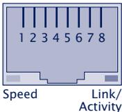
Der Netzwerkanschluss ist sowohl gegenüber der Versorgungsspannung als auch gegenüber der seriellen Schnittstelle mit  $1,5\text{kV}_{\text{rms}}$  galvanisch getrennt.
