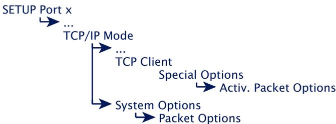
Bei der Übertragung serieller Protokolle wie zum Beispiel Modbus/RTU, ist es oft notwendig seriell empfangene Datagramme auch netzwerkseitig geschlossen in einem TCP-Paket zu übertragen. Die oben angeführten Menüzweige bieten diverse
