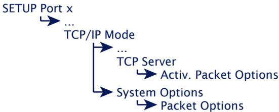
Bei der Übertragung serieller Protokolle wie zum Beispiel Modbus/RTU, ist es oft notwendig seriell empfangene Datagramme auch netzwerkseitig geschlossen in einem TCP-Paket zu übertragen. Die oben angeführten Menüzeile bieten diverse Möglichkeiten serielle Paketgrenzen zu parametrieren (Pausenzeiten, Start-/Endesequenzen, Datagramm-Längen) und deren Auswertung für die jeweilige Betriebsart zu aktivieren. Details enthält das Kapitel *Das Menü ... Setup TCP/IP → System Options*.
