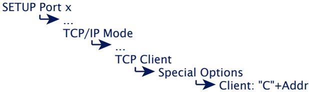
In dieser Betriebsart werden die Adressdaten des Servers nicht fest konfiguriert, sondern als Steuerkommando vor den eigentlichen Nutzdaten seriell an den Com-Server übermittelt. Hierdurch ist es möglich, Verbindungen zu wechselnden TCP-Servern aufzunehmen.
