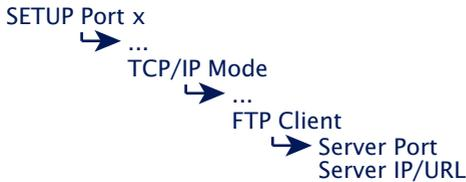
Unabhängig davon, ob das FTP-Protokoll automatisch oder mit Hilfe des seriellen Steuerstrings abgewickelt wird, werden die Adressdaten des gewünschten FTP-Servers statisch konfiguriert.
