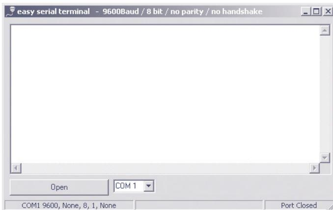
Verbinden Sie den seriellen Port A des Com-Servers mit Ihrem PC und führen durch Unterbrechen der Spannungsversorgung einen Reset durch. Halten Sie *während* des Neustarts die x-Taste (klein, ohne CapsLock!) gedrückt. Nach ca. 2-3 Sekunden erscheint im Terminalfenster die Eingabeaufforderung *IP no.:+<ENTER>:*.
