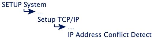
Bei einem Neustart des Com-Servers erfolgt eine aktive Prüfung auf eventuelle Adresskonflikte. Im laufenden Betrieb arbeitet die Überwachung passiv. Details zur Funktionsweise enthält die RFC5227, *IPv4 Address Conflict Detection*.
