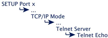
Beim Öffnen einer Telnet-Verbindung wird netzwerkseitig zwischen den Teilnehmern verhandelt, wer das Echo der vom Client gesendeten Zeichen erzeugt. Entweder generiert die Client-Anwendung ein lokales Echo, oder das serielle Gerät erzeugt ein Remote-Echo, indem es alle empfangenen Zeichen sofort wieder zurücksendet. Die Telnet-Echo-Option am Com-Server ist wie folgt definiert:
