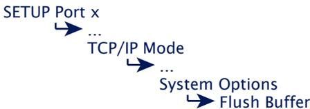
Die Option bestimmt, ob bei einem netzwerkseitigen Verbindungsaufbau zum Com-Server der serielle Eingangsbuffer gelöscht wird (*Flush Buffer = 1*), oder eventuell vorhandene Daten an die Client-Anwendung übertragen werden (*Flush Buffer = 0*). Details enthält das Kapitel *Die Basiskonfiguration des Com-Servers*.
