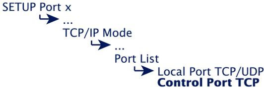
Wurde innerhalb der *COM-Umlenkung* ein von der Werkseinstellung abweichender TCP-Port eingegeben, müssen die entsprechenden Werte auch in den oben angeführten Menüzeilen des Com-Servers konfiguriert werden. Die von der COM-Umlenkung genutzte Control Port Nummer errechnet sich immer aus der Formel *Datenport + 1094*.
