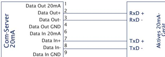
**Com-Server Sendeschleife aktiv, Empfangsschleife passiv**
