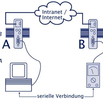
**Beispiel 3:** Ein Steuer-Programm pollt mehrere Meßgeräte, die Meßgeräte können (z.B. im Fehlerfall) selbständig Daten an das Steuer-Programm senden.
