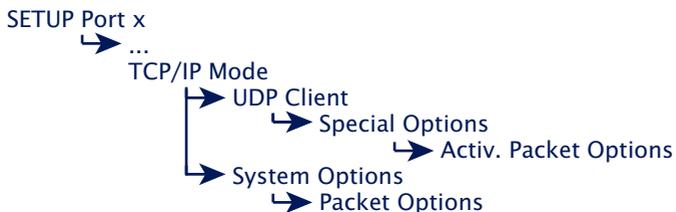
Bei der Übertragung serieller Protokolle wie zum Beispiel Modbus/RTU, ist es oft notwendig seriell empfangene Datagramme auch netzwerkseitig geschlossen in einem TCP-Paket zu übertragen. Die oben angeführten Menüzeile bieten diverse Möglichkeiten serielle Paketgrenzen zu parametrieren (Pausenzeiten, Start-/Endesequenzen, Datagramm-Längen) und deren Auswertung für die jeweilige Betriebsart zu aktivieren. Details enthält das Kapitel *Das Menü ... Setup TCP/IP → System Options*.
