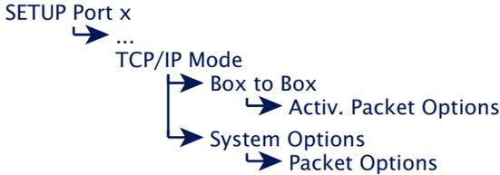
Bei der Übertragung serieller Protokolle wie zum Beispiel Modbus/RTU, ist es oft notwendig seriell empfangene Datagramme auch netzwerkseitig geschlossen in einem TCP-Paket zu übertragen. Die oben angeführten Menüzeile bieten diverse Möglichkeiten serielle Paketgrenzen zu parametrieren (Pausenzeiten, Start-/Endesequenzen, Datagramm-Längen) und deren Auswertung für die jeweilige Betriebsart zu aktivieren. Details enthält das Kapitel *Das Menü ... Setup TCP/IP → System Options*.
