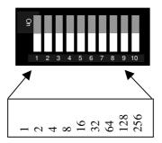
Die Umschaltung zwischen DALI und DSI Ausgangssignal erfolgt über den Schalter 10:
