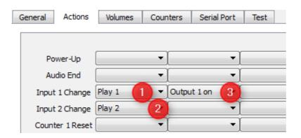
Um einige Sekunden zeitverzögert soll der Strahler wieder ausgeschaltet werden. Eine solche Verzögerung wird auf dem Codespot Pro mit Hilfe eines Zählers erzeugt. Diesem Zähler wird ein Startwert übergeben, der kontinuierlich herunter gezählt wird. Das geschieht entweder zeitgesteuert über die 0,1- oder 10-Sekunden-Clock oder manuell durch Auslösen der Aktion Counter Decrement. Erreicht ein Zähler den Wert null, wird das Ereignis Counter Reset eingeleitet.
